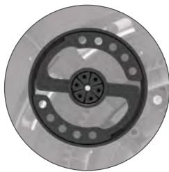
**Hamulec odśrodkowy zapewnia bezpieczną prędkość zwijania węża**
